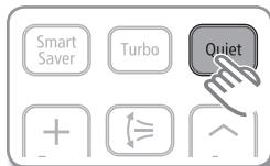
Нажмите кнопку Quiet(Тихий режим)на пульте дистанционного управления, если кондиционер работает в режиме Охлаждение/Обогрев.
