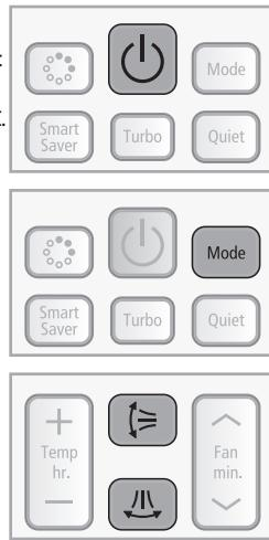
Режим охлаждения (проверка внутреннего блока) → Температура поступающего воздуха.
