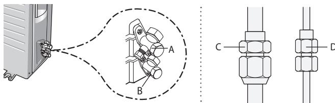
Чтобы проверить отсутствие утечек газа на наружном блоке,
