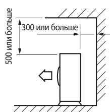
◆ Если стены блокируют переднюю и заднюю стороны наружного блока
