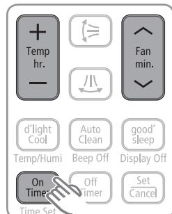
1. Нажмите кнопку **Таймер включения/Таймер отключения**
