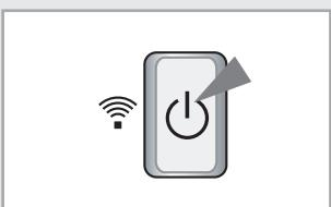
2 Чтобы включить кондиционер, нажмите выключатель Вкл/Выкл на правой стенке комнатного блока.
