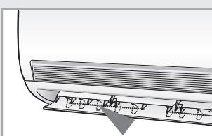
*Имеются два комплекта внутренних пластин для регулирования направления потока воздуха. Так же как вы можете изменять положение наружной пластины в вертикальной плоскости, вы можете изменять положение внутренних пластин в горизонтальной плоскости.*
