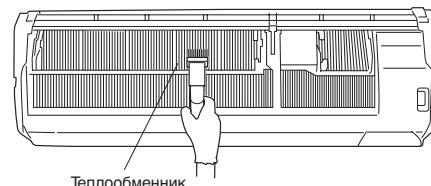
Очистить поверхность теплообменника можно, установив на пылесос щетку из КОМПЛЕКТА БЫСТРОЙ ОЧИСТКИ. Подробные указания по очистке приведены в руководстве к КОМПЛЕКТУ БЫСТРОЙ ОЧИСТКИ (упакованному вместе с наружным прибором).
